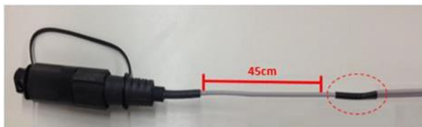
Figura 1 – Ejemplo de Drop Pre conectorizado con retirada del mensajero y protección por termo contráctil
